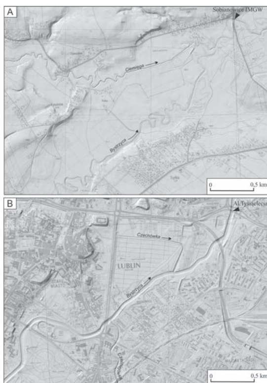
Rys. 3. Fragmenty doliny Bystrzycy: A – meandrujące koryto Bystrzycy po szerokiej zalewowej poniżej Lublina (naturalny), B – wyprostowany i obwałowany odcinek miejski Bystrzycy
